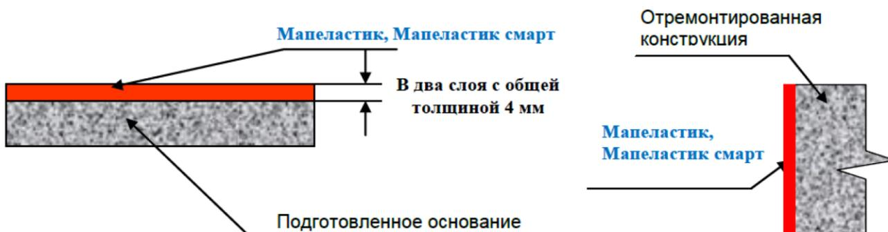
**Уход за гидроизоляционным слоем** включает в себя периодическое увлажнение поверхности водой в течение первых 24 часов. Отсутствие мер по влажностному режиму может привести к образованию микротрещин на поверхности гидроизоляционного слоя.
