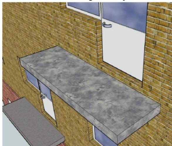
8. Нанесение финишного отделочного слоя **Planitop 400** для создания эстетичной поверхности. Данный состав можно наносить на «молодой» бетон в возрасте 1 – 2 суток.
