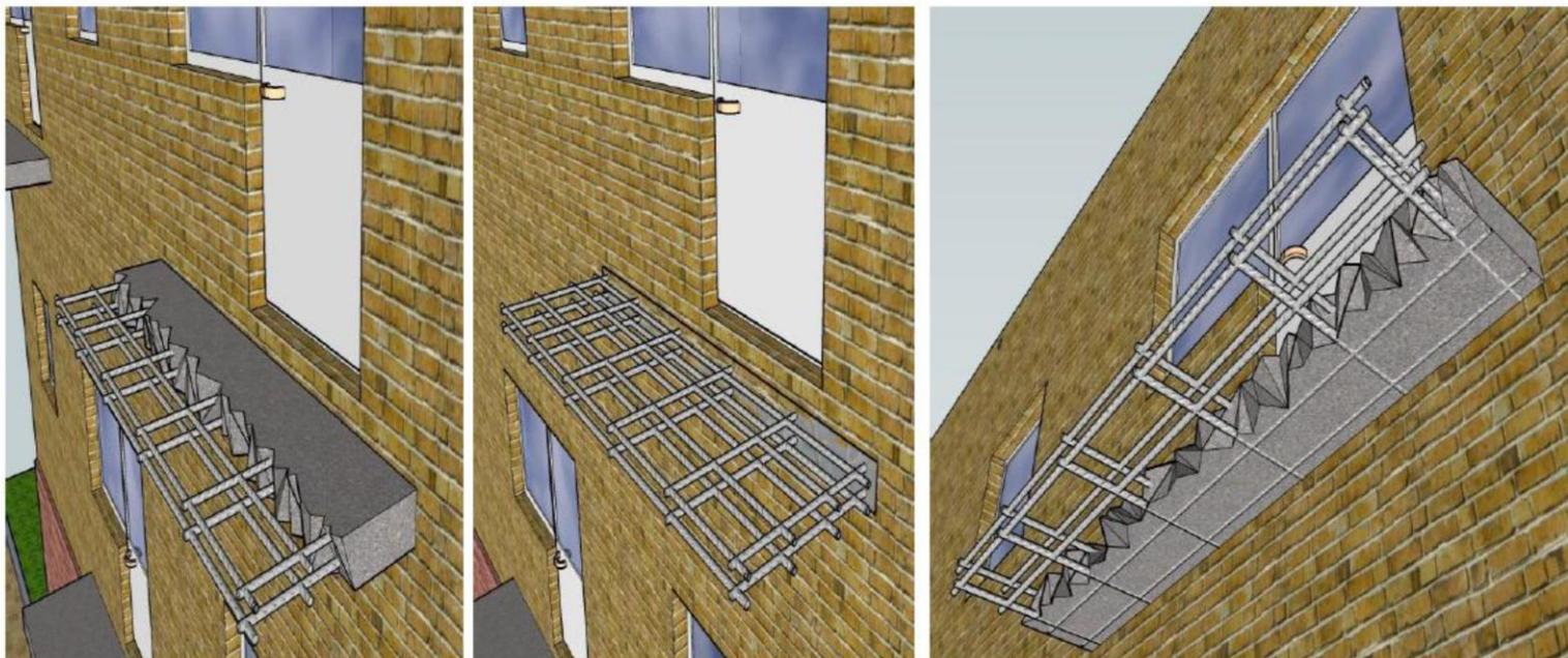
Конструктивно балконная плита представляет собой консольную плиту, защемленную в стене. Изгибающие моменты воспринимает продольная стальная арматура Ø18 – 20 мм. Присутствует арматурный стальной сварной каркас при толщине защитного слоя бетона 15 – 20 мм.
